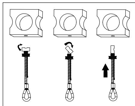
2. Tourner la barre de basculement pour l'amener en position ouverte et l'insérer dans le trou.
