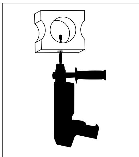
2. Otočte rozpínací tyč do otevřené polohy a zasuňte ji do otvoru.
