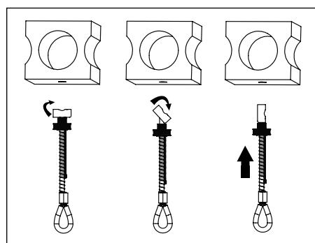
2. Ruotare la barra di sicurezza in posizione aperta e inserirla nel foro.
